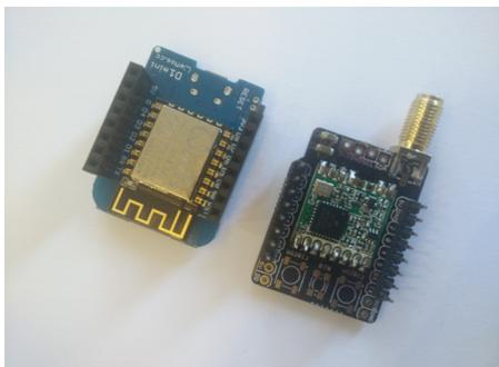
Figura 10.3: Shield LoRa (a dx) per MCU Wemos/ESP8266
