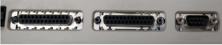
Figura 5.1: Connettori DB9 e DB25 sul retro di un terminale “vintage”
