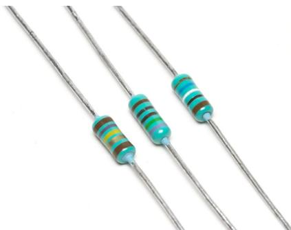
Figura 3.9: Resistenze per elettronica di bassa potenza (fonte: wikipedia)
