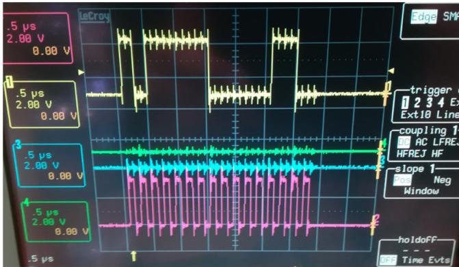
Figura 5.9: Trasmissione 16bit SPI
