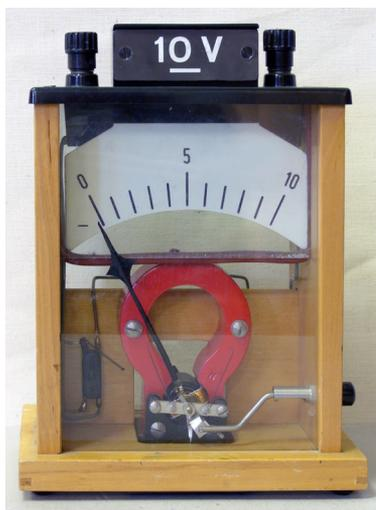
Figura 3.24: Voltmetro analogico (fonte: Hannes Grobe)
