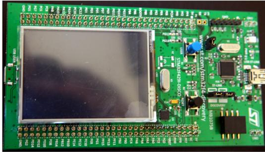
Figura 4.1: Una discovery board STM32 F429 dotata di LCD
