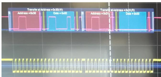
Figura 5.7: Scrittura Registro su I2C vista su oscilloscopio
