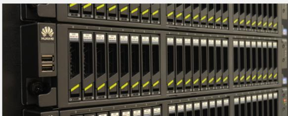
Qui sopra una batteria di dischi RAID, gli incavi che si vedono sono per estrarli facilmente, a mani nude, in caso di sostituzione.
